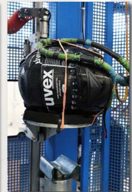
Realitätsnaher Sturz auf den Sigma-Pfosten: der Uvex beim Seitenschlag.
