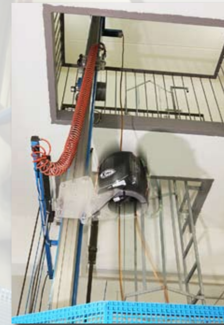
Beim Kinnschlagtest fallen die Helme mit 7,5 m/s auf einen Kantenamboss.
