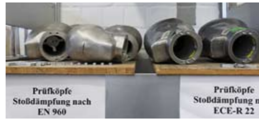
Hinter den Kulissen beim TÜV: Datenblätter mit Schlagdämpfungs-Ergebnissen (oben) und Metall-Prüfköpfe in verschiedenen Größen (unten).
